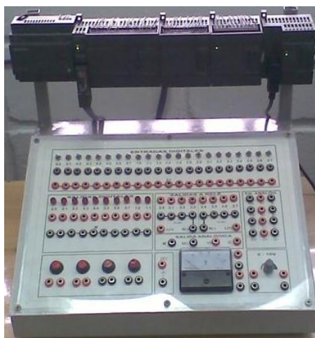
Figura 11. Banco del PLC S7-200 Siemens
