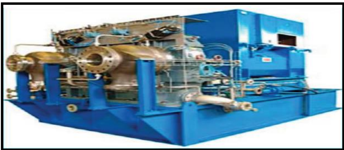
Ilustración 9: Turbina de Expansión
